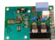
Печатная плата для плавного пуска однофазного электродвигателя
