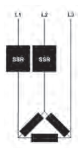
Двухфазное ТТР SOB для контроля нагревательных элементов, соединенных треугольником (для сбалансированных или несбалансированных нагрузок высокого напряжения)
